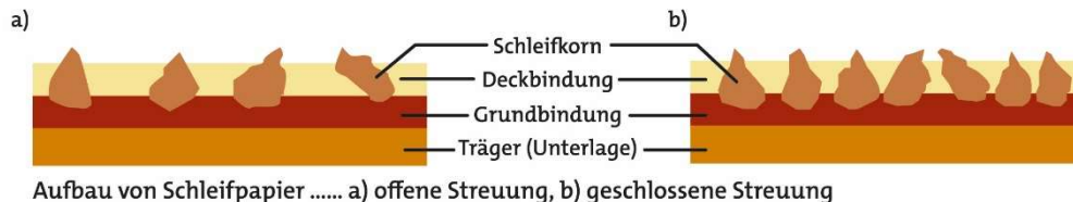
Abb. 1: Aufbau von Schleifpapier a) offene Streuung, b) geschlossene Streuung (aus Holztechnik Fachkunde, 24. Auflage Verlag Europa Lehrmittel)
